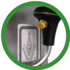
An der linken Seite der Maschine serienmäßiger (EN 609-1:2017) montierter Stammheber mit Doppelfunktion als Holzhaltebügel. Arretierbar am Ende der Arbeit
